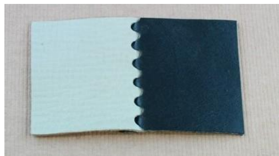
写真-1b 交差つなぎ つないだ表面
